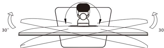
Angolo di rotazione della testa del monitor:  $L30^{\circ}, R30^{\circ}$
