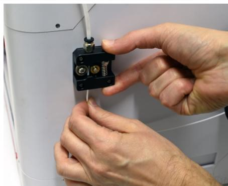
3. Spingere il filamento per farlo scorrere all'interno del tubo portacavo fino all'ingresso della testina di stampa dopodiché rilasciare l'estrusore.
