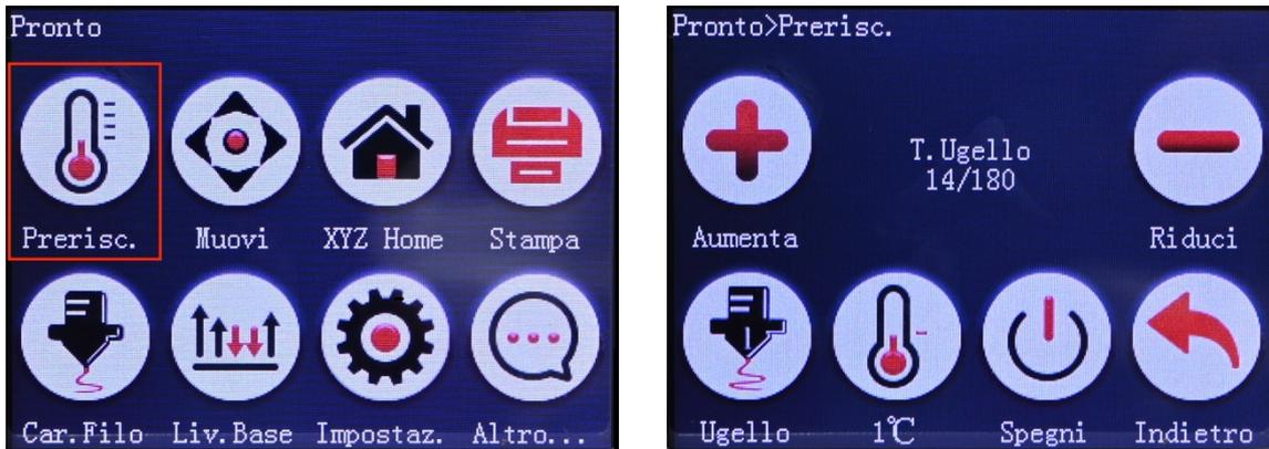
2. Premere più volte sull'icona “+” per aumentare il valore della temperatura dell’ugello fino ad una temperatura di 200 °C.
