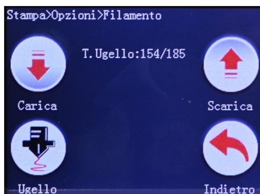
3. Una volta rimosso il filamento, sarà possibile inserire quello nuovo.
