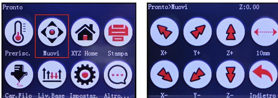
Importante: effettuare come primo spostamento quello dell’asse “Z” in modo da alzare la testina ed evitare collisioni con il tappetino magnetico.
