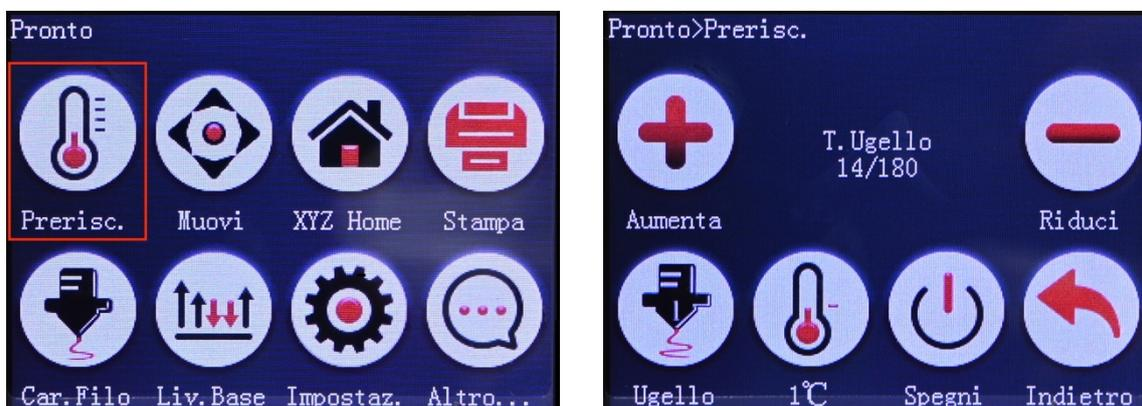
6. Premere più volte sull'icona "+" per aumentare il valore della temperatura dell'ugello fino ad una temperatura di 200 °C.
