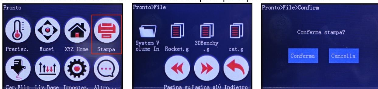
3. Al termine del riscaldamento dell'ugello e del piano, la stampante inizierà la creazione del modello e sul display verrà visualizzata la schermata di avanzamento della stampa.
