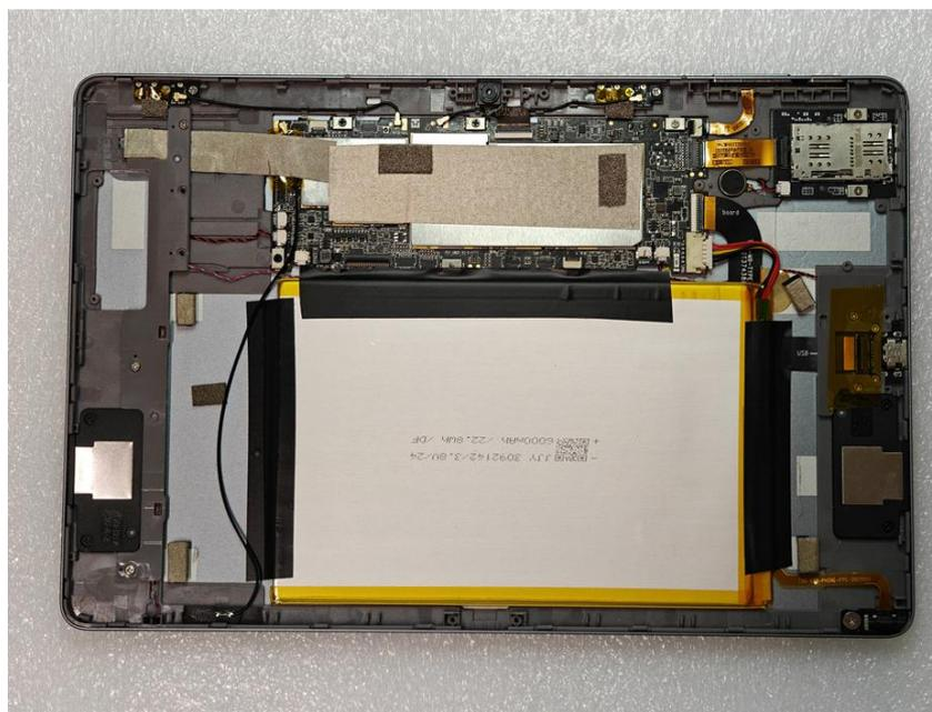
Rimuovere l'adesivo posto ai lati della batteria utilizzando le apposite pinzette antistatiche, con delicatezza e facendo attenzione ad eventuali flat o cavi vicini al nastro.
