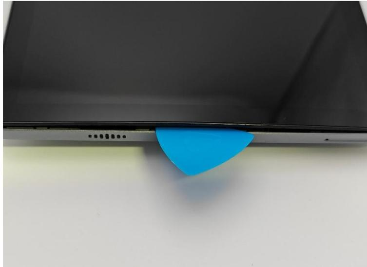
Una volta creata la prima apertura scorrere lungo i bordi del tablet in modo da sbloccare uno per volta tutti i blocchi di chiusura.
