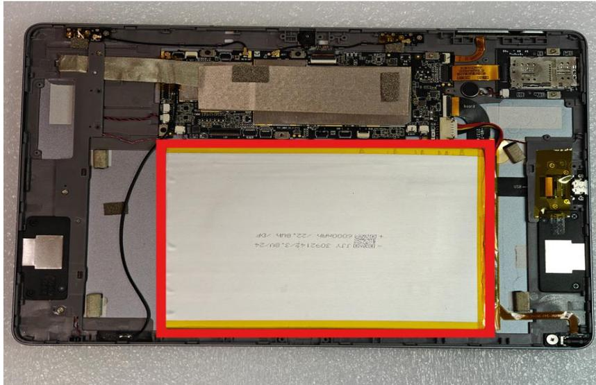
Collegare con attenzione il connettore della batteria alla piastra madre del dispositivo come da foto sotto riportata.
