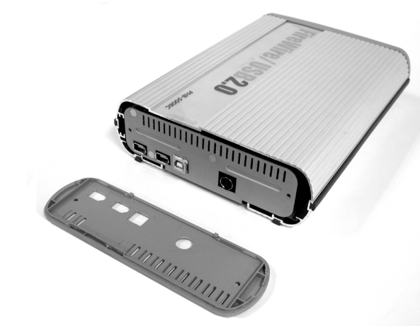
2. Rimuovere il pannello posteriore
