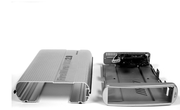
2. Rimuovere il pannello posteriore
