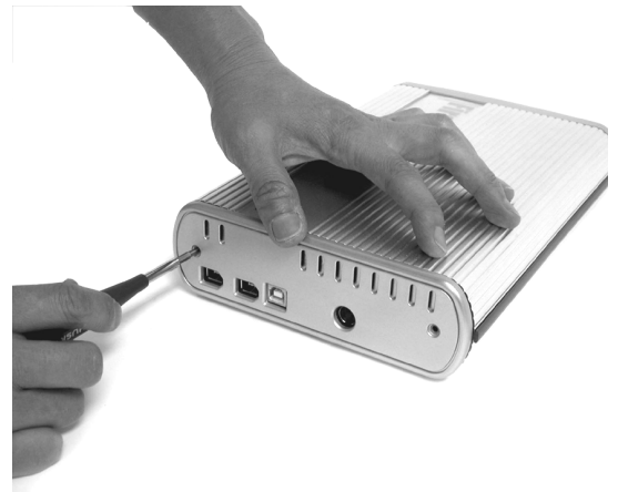
10. Riposizionare il pannello posteriore nel suo alloggiamento e fissarlo con 2 viti da 5mm
