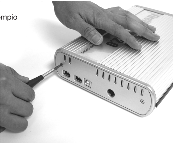
1. Svitare le due viti che assicurano il pannello posteriore
