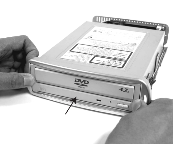
7. Inserire il Drive all'interno della basetta alloggiamento
