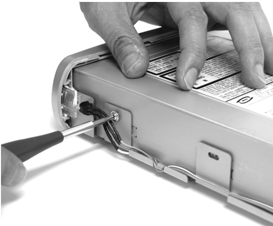
8. Assicurare il Drive alla basetta da entrambe le parti (7 viti da 7 mm)
