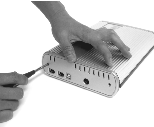
10. Riposizionare il pannello posteriore nel suo alloggiamento e fissarlo con 2 viti da 5mm
