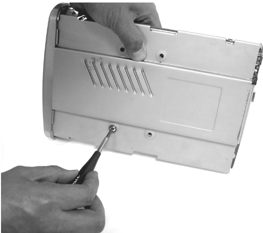
8. Allineare i fori dell’Hard Disc a quelli della basetta ed assicurare il disco con 4 viti da 10 mm
