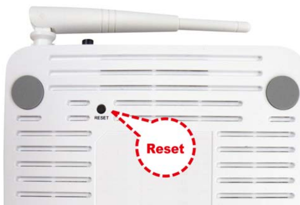
Figura 3. Posizione del pulsante di Reset (sotto al Router)
