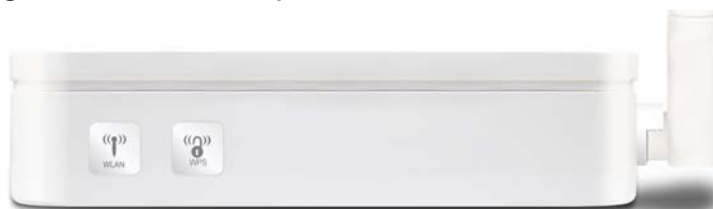
Figura 2. Posizione dei pulsanti WLAN e WPS a lato del Router
