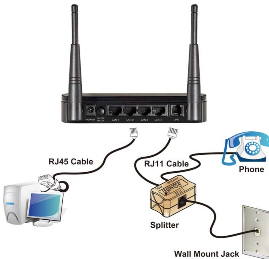
1. Collegate il cavo Ethernet RJ45 in dotazione dalla porta Ethernet del vostro PC ad una delle 4 porte LAN del Router.
